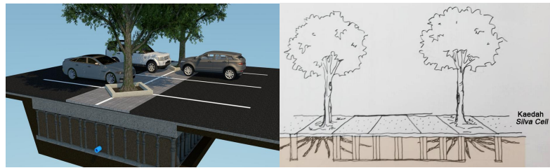
Gambar 10 : Penggunaan sistem silva cell bagi mengurangkan kerosakan akar pokok.
