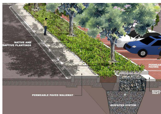
Gambar 9 : Penggunaan bahan yang dapat menyerap air secara semula jadi ketika hujan bagi mengelakkan kawasan dibanjiri. Sumber : Internet
